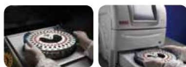
PŘENOS LAHVÍČEK z přístroje ALFRED 60 do HB&L pomocí mechanického držáku, díky kterému lze přenést celý rack
